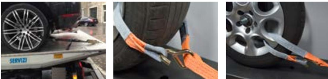
Il Sistema di ancoraggio ideale per fissare il veicolo tramite la ruota. I veicoli con ruote in acciaio vengono ancorati inserendo direttamente il gancio nella ruota. I veicoli con ruote in lega vengono ancorati tramite la speciale asola.
